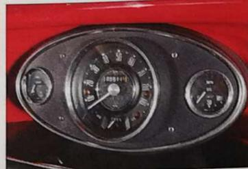
Le tableau de bord ovale regroupe au centre le tachymètre et sur les côtés les voyants de température d'eau et de pression d'huile.
