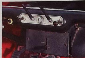
De part et d'autre de l'emplacement de la clé de contact, ces prolongateurs sont pratiques pour actionner les essuie-glace ou l'éclairage.
