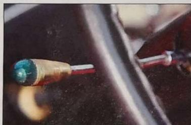
L'extrémité de la manette des clignotants est équipée d'une diode lumineuse qui s'allume quand ils sont en fonction.
