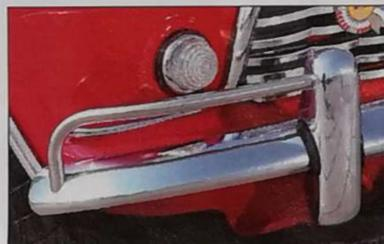
Les tubes de protection d'angles des pare-chocs, qu'on appelle «corner bar», sont spécifiques aux Mk I. Ils disparaissent à l'automne 1967 avec la Mk II.
