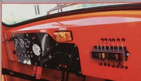
Le tableau de bord réduit à l'essentiel. Notez la position accessible des fusibles. Le shift light (gros clignotant central) et le compte-tours face au volant donnent le ton.
